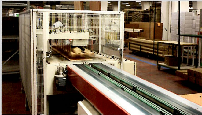
Palletizzatore e doppio trasporto a tappeto con piano centrale sollevabile
