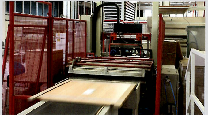
Ribaltatore a 180° con piano inferiore e superiore motorizzato su linea imballaggio
